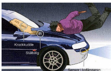
Exempel på teknisk lösning som minskar skaderisken vid påkörning av fotgängare. Bild ur Autoliv Inc årsberättelse år 2002.
