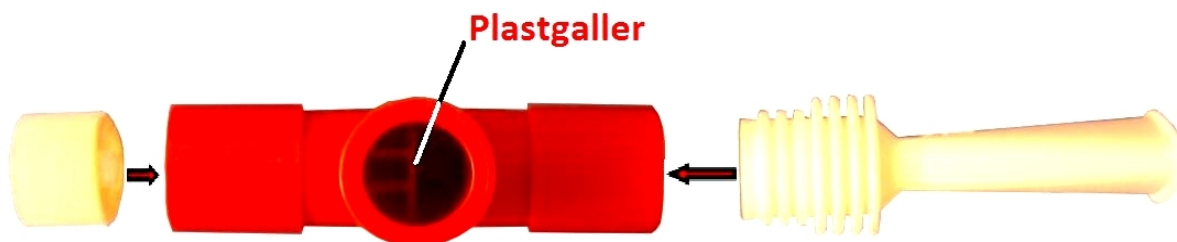
Bild 9. Montering av backventil och munstycke i förhållande T-styckets plastgaller.
